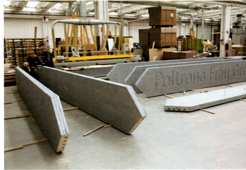
FACCIAIE / WALLS SISTEMA A SETTI INCROCIATI COMBINIBILI. SYSTEM WITH SEVEN INTERSECTING STRUTS. MODULO / MODULE 5 X 5 M
